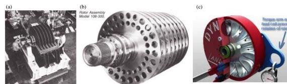
圖 7、水制動動力計吸收盤原理：(a) 平滑圓盤 (Courtesy of Kahn®)；(b) (Courtesy of Kahn®) 與 (c) 凹孔導流型 (Courtesy of DYNOMite®)
